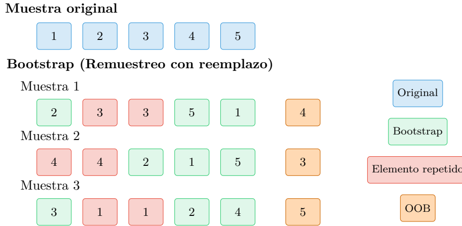
Figura 2.11: Ilustración de la técnica de remuestreo bootstrap.
