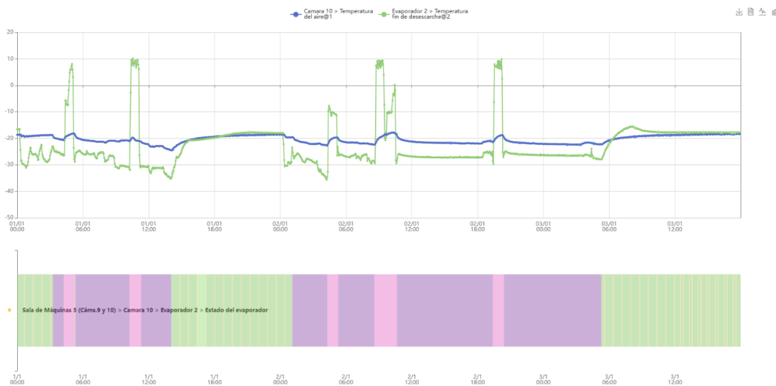
Figura 4.1: Datos das variables para a presenza de xeo no evaporador: temperatura de fin de desescarche (liña azul), temperatura do aire (liña verde) e estado do evaporador, representado no gráfico de cores da parte inferior da imaxe.
