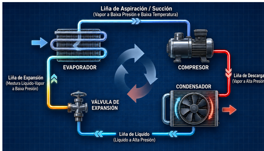
Figura 1.3: Ciclo de refrigeración.
