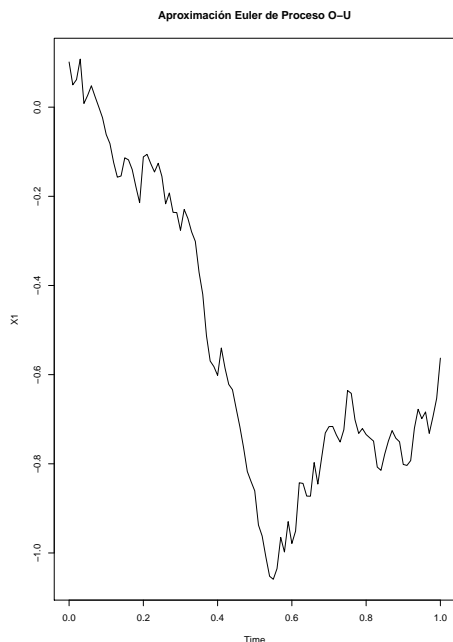
Figura 4.2: Trayectoria simulada del proceso de Ornstein-Uhlenbeck mediante el esquema de discretización de Euler cuyo funcionamiento es bueno siempre que \Delta sea pequeño; con un \Delta grande, presenta dificultades, llegando incluso a explotar.
